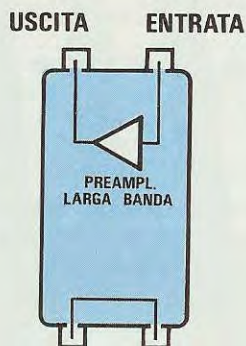
Fig.360 Nei PREAMPLIFICATORI a LARGA BANDA, delle due prese poste in alto una serve per l'ENTRATA del canale o dei canali che desiderate preamplificare e l'altra, indicata USCITA, per prelevare il segnale preamplificato.
